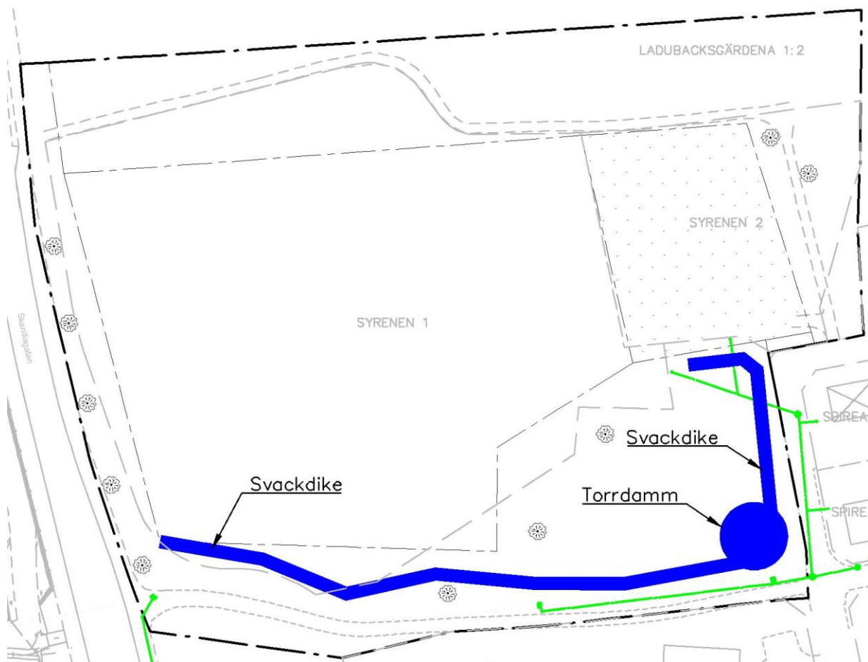
Figur 9. Översiktlig skiss dagvattenhantering på allmän platsmark.
